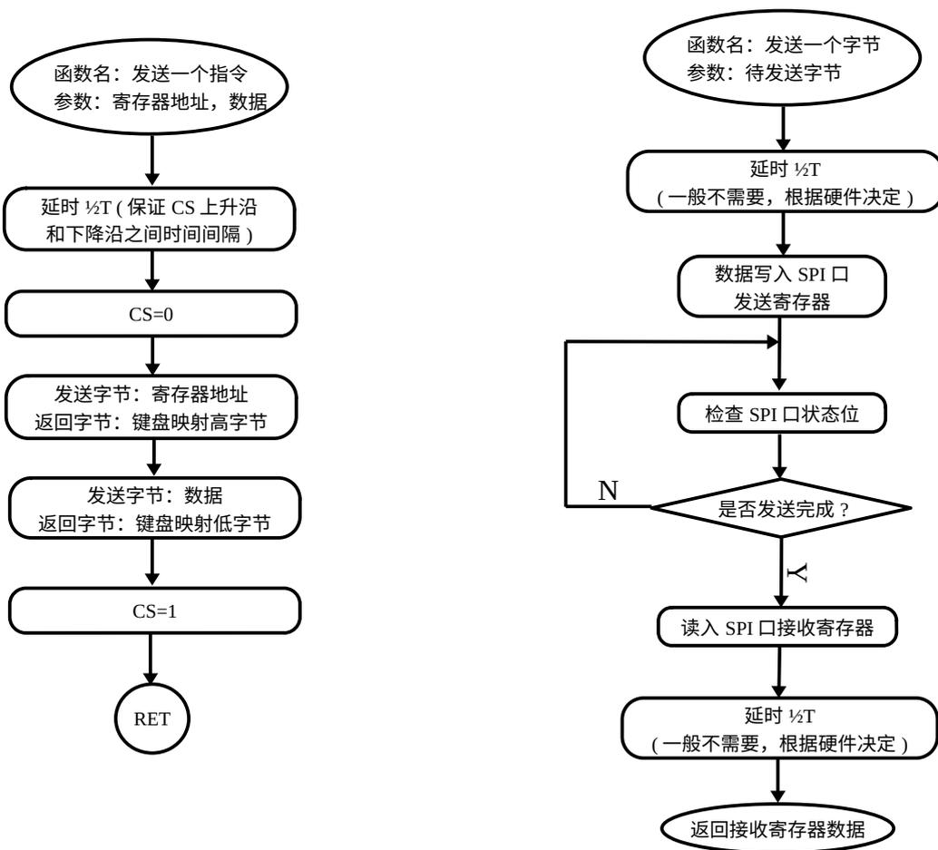
硬件 SPI 接口+中断方式流程图:
