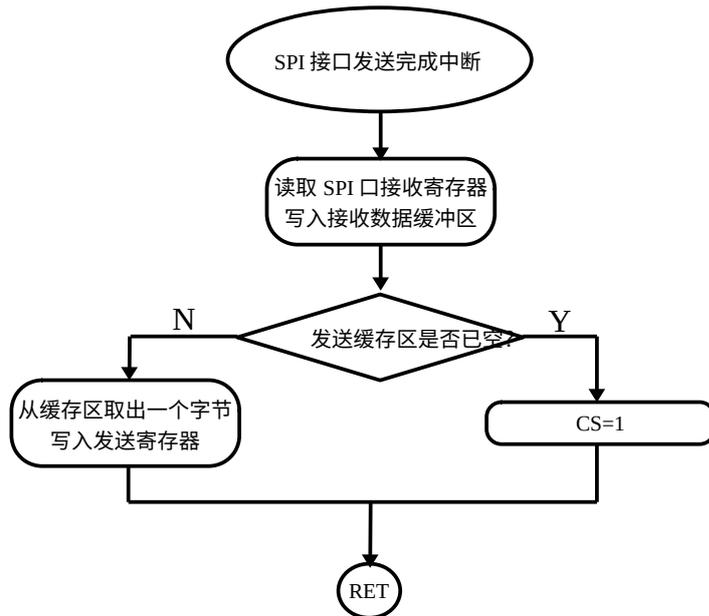
注: 在中断方式下, 因为缓冲区的存在, “发送一个指令”子程序的调用和数据实际在 SPI 口上发出的时间会有不同步的问题, 同样原因, 在“发送一个字节”子程序中, 无法返回读入的键盘映射数据。因此在使用中断方式通讯时, 在设置发送缓冲区的同时, 还需要一个接收缓冲区, 用来存放接收到的键盘映射数据。程序在 SPI 口发送完成中断处理子程序中, 首先将接收寄存器的内容写入接收缓冲区, 然后再将下一个待发送数据写入发送
