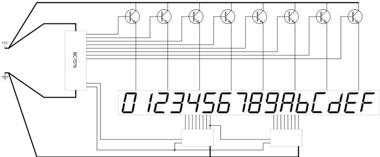
电路板的布线，需要予以重视，建议将 BC7276 的电源和地线与驱动三极管的电源和移位寄存器的地线分别走线，并在电源一点接地。
