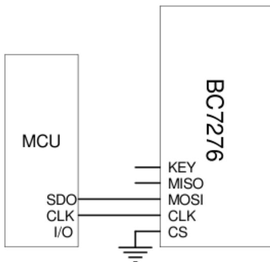
一般 MCU 上 SPI 接口均可设置不同的工作模式，与 BC7276 相连时，应该设置成主机 (Master) 模式，CLK 空闲时高电平，数据在第一个时钟沿传递，在第二个时钟沿采样。接口的时钟频率，必须在 64KHz 以下。
