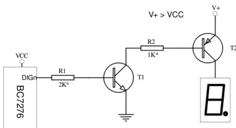
NPN型晶体管T1和PNP型晶体管T2组成驱动电路，对晶体管的选择没有什么特殊要求，只需耐压 $>V+$ 即可，因为LED串联方式下，工作电流并无增加，因此T2的工作电流与标准连接方式相同。R1和R2的选择，只需遵循让T1和T2工作在深饱和状态的原则，计算公式如下：
