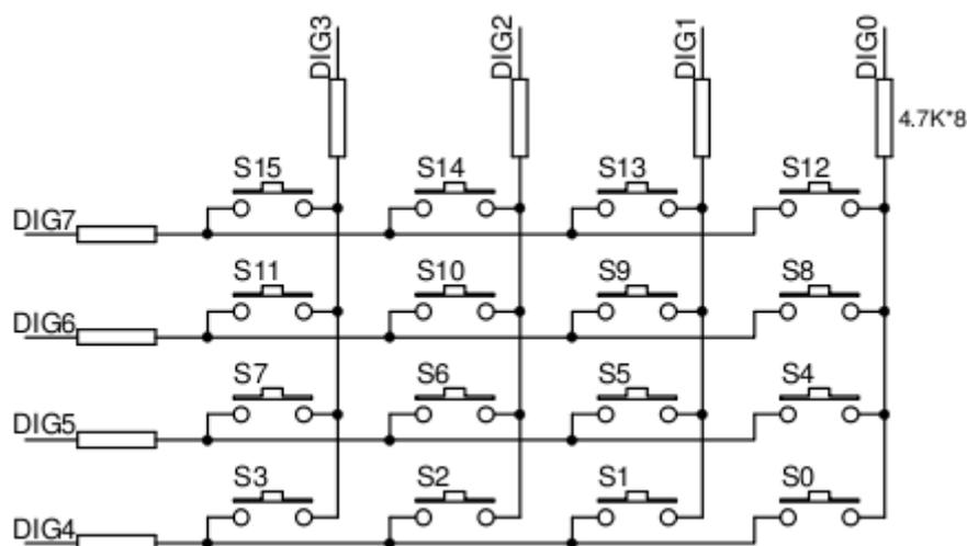
矩阵的行和列上，都需要串入电阻，电阻的作用在于防止位驱动输出之间的短路，4.7K 的阻值可以适用于大多数情况。
