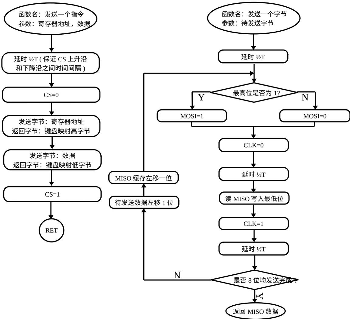
硬件 SPI 接口+查询方式流程图:
