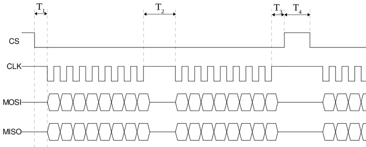
图中， $T_1$  为指令中 CS 下降沿到第一个 CLK 时钟脉冲下降沿的时间，此时间要求大于  $\frac{1}{2}$  个时钟周期 T，当使用硬件 SPI 接口时，从数据写入 SPI 接口发送寄存器到第一个时钟脉冲输出，一般会加入约 1 个时钟周期的延时，用户使用程序中将 CS 置低电平，然后写入 SPI 接口寄存器即可，对此延时可不予考虑，但如果所用 MCU 的 SPI 接口没有此特性，或者使用软件模拟 SPI 接口，则需人工加入此延时。
