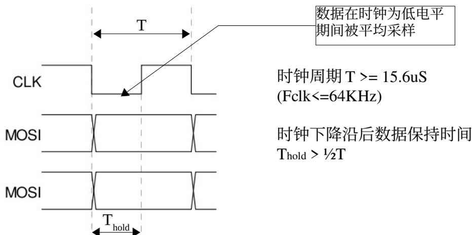
对于使用硬件 SPI 接口的情况，请设置 SPI 接口为如下参数: CLK 空闲状态为高电平，数据在第一个时钟沿(下降沿)改变，在第二个时钟沿(上升沿)被采样，串口速率 $\leq 64\text{Kbps}$ 。
