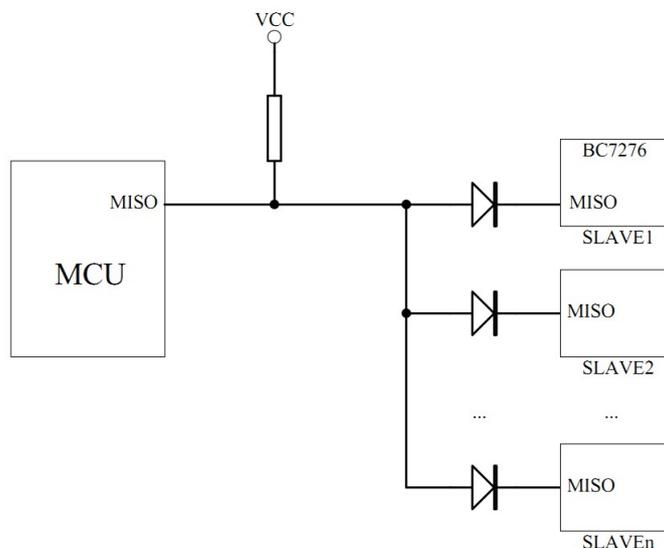
因为接口部分的高电平最低输入电压在电源电压为 5V 时为 3.7V，因此，如果 BC7276 的电源电压为 5V，无法直接与 3V 系统接口，但因 BC7276 本身可工作在 3V 电源电压下，因此当系统 MCU 为 3V 或 3.3V 供电时，建议 BC7276 也采用相同的供电电压，如果需要用更高
