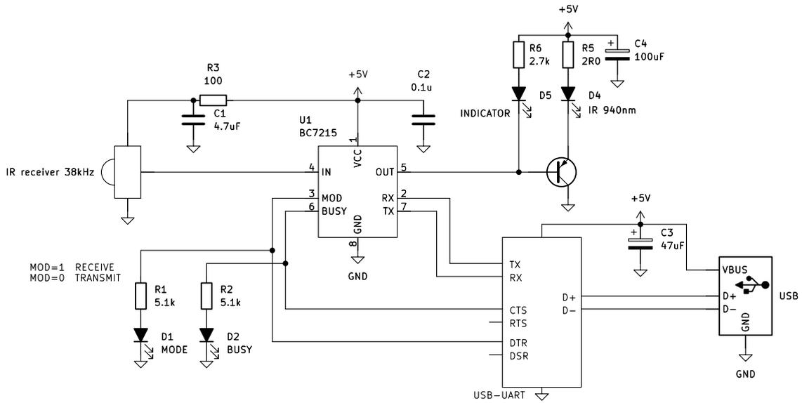
(与电脑连接时, 请注意所使用的系统驱动应支持 USB-UART 芯片的硬件流控制, 否则可能会造成 BC7215 UART 缓冲区溢出而引起长数据的红外数据发送失败)
