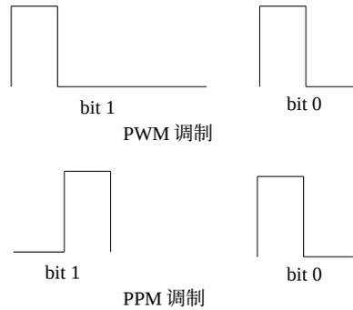
调制的类型决定一个关键因素，即数据发送的顺序。红外数据是串行数据，不同的遥控器格式规定了不同的数据排列顺序，是高位 MSB 先传送还是低位 LSB 先传送。BC7215 对所有采用脉冲宽度 PWM 编码的红外信号，均按照低位 LSB 在前进行解码，与该格式最常见的遥控芯片 NEC 编码所使用的方式相同。而对于 PPM 格式，则按照高位 MSB 在前进行解码，同该格式最常见的 RC5 编码遥控芯片。请参见后文《数据位对齐方式》部分。
